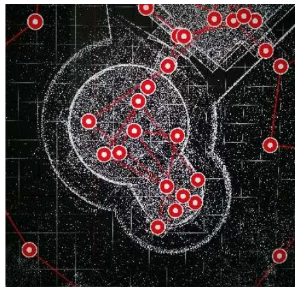
obr. č. 50: kontrola napojení skenů v terénu; vlastní zdroj
