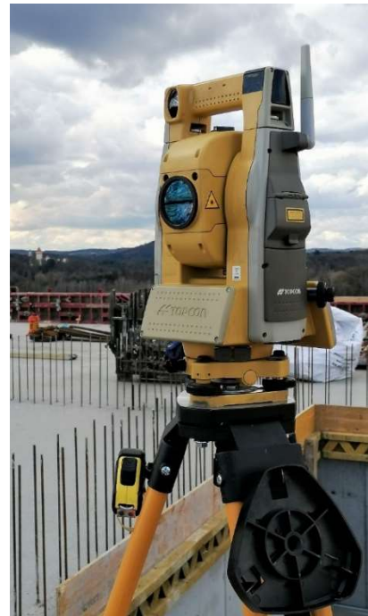
obr. č. 29: robotická totální stanice Topcon GPT-9003A; vlastní zdroj
