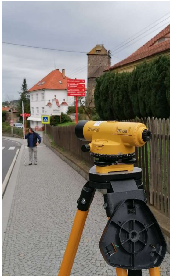
obr. č. 28: nivelační přístroj Topcon AT-G3, technická nivelace; vlastní zdroj
