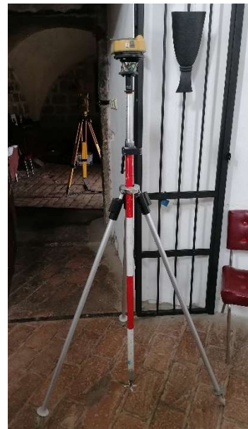
obr. č. 41: tvorba bodového pole v interiéru; vlastní zdroj
