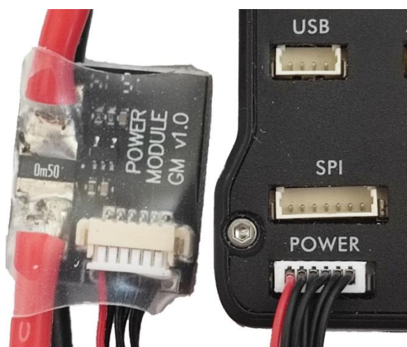
Obrázek 52: Zapojení napájecího modulu [10]
