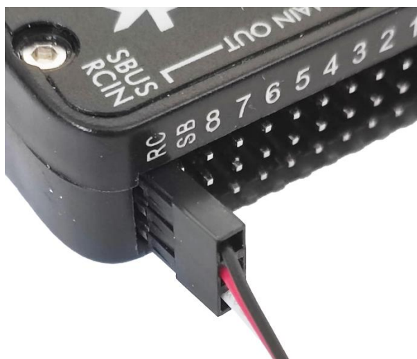
Obrázek 50: Zapojení PPM enkodér – Pixhawk [10]
