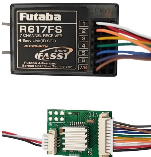
Obrázek 51: Zapojení PPM enkodér – rádio anténa [10]
