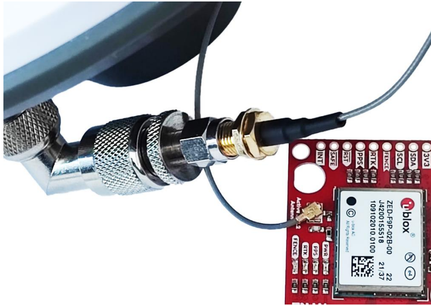
Obrázek 62: Zapojení u-blox – GNSS anténa [10]
