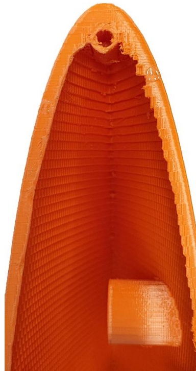
Obrázek 37: Vnitřní hrana před a po zahlazení [10]
