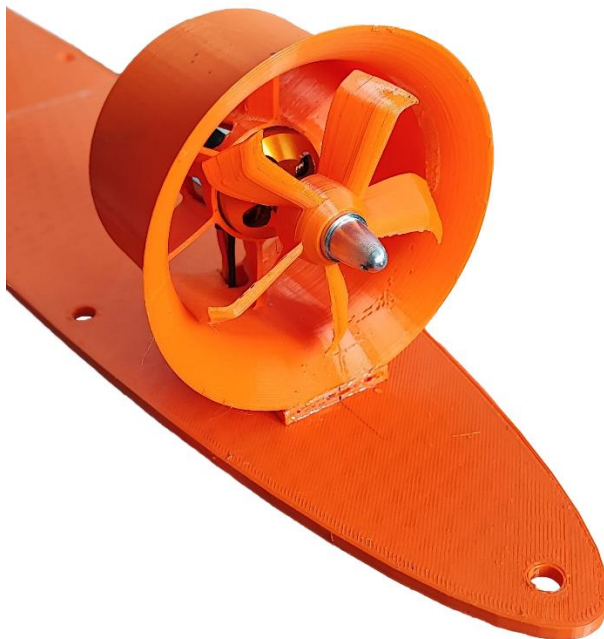
Obrázek 48: Připevněný kryt s usazeným motorem [10]
