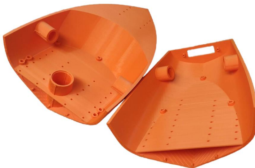
Obrázek 26: Vytištěný hlavní trup plavidla [10]
