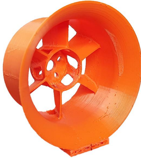
Obrázek 47: Broušením upravený kryt motoru [10]
