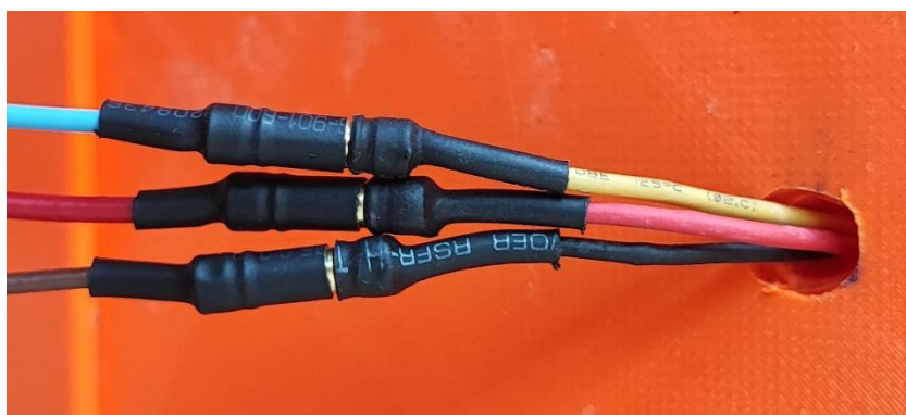
Obrázek 56: Zapojení regulátoru otáček do motoru [10]
