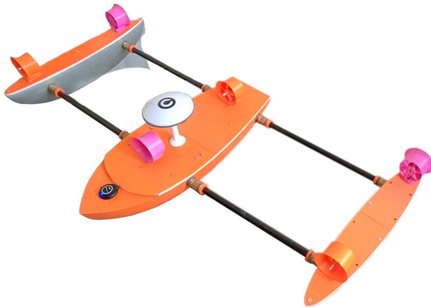
Obrázek 65: Připojení antény GNSS na plavidle[10]
