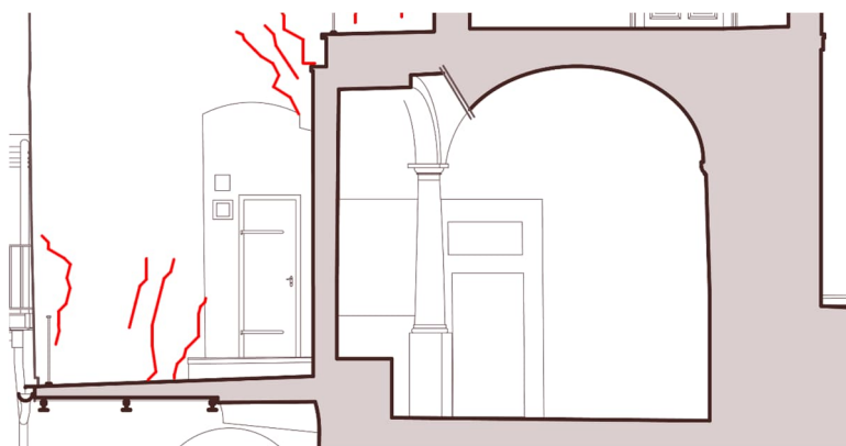
Obrázek 4 - Trhliny východní stěny v přízemí [8]
