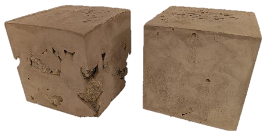
Obrázek 19 - směs Sorfix/CEM I "B" (poslední a první vyhotovený vzorek dle betonáže)
