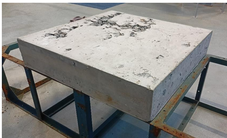
Obrázek 23 - reálný vzorek (deska na ocelovém podstavci s viditelnými kavernami)
