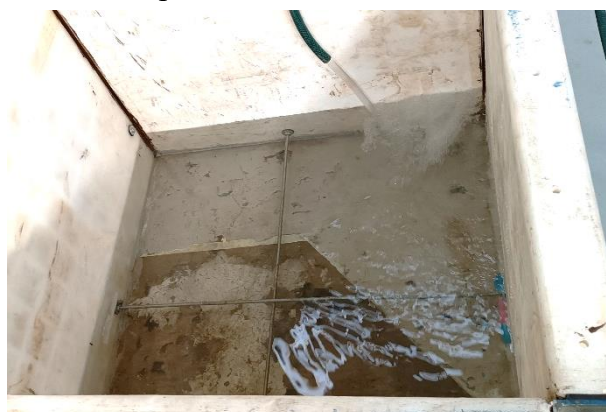
Obrázek 28 - reálný vzorek (zkušební zalití vzorku po utěsnění části desky)
