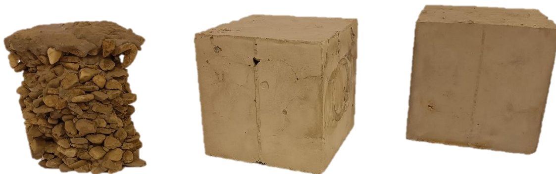
Obrázek 32 - zleva: první vzorek, vzorek CEM III + přísady, vzorek Sorfix/CEM I "C"
