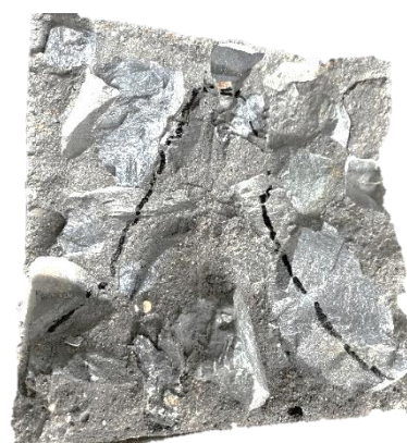
Obrázek 24 - zkušební těleso s čarou průsaku
