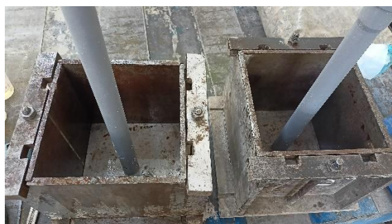
Obrázek 5 - technologický postup (připravené vzorky k betonáži)
