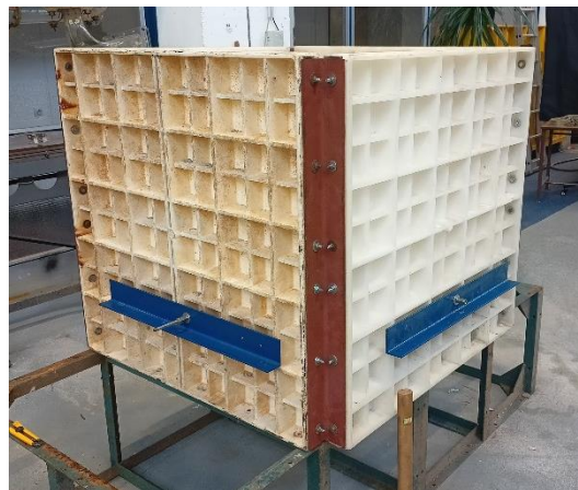
Obrázek 26 - reálný vzorek (pohled na připravenou zkušební nádrž)
