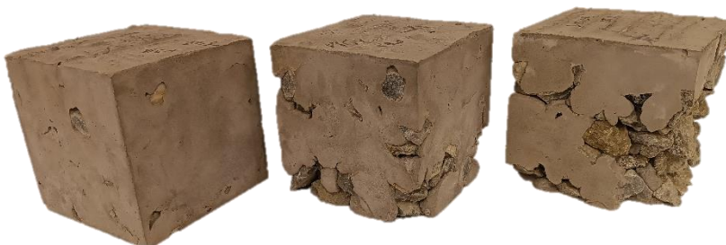
Obrázek 18 - směs Sorfix/CEM I „A“ (vyhotovené vzorky dle průběhu betonáže zleva)
