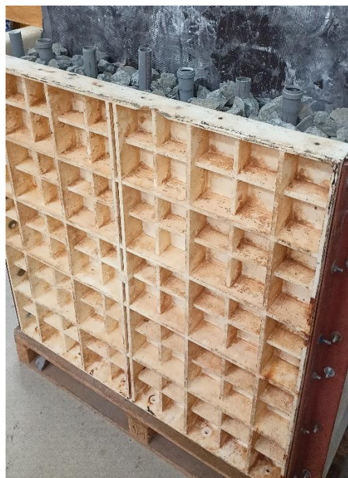
Obrázek 22 - reálný vzorek (připravený vzorek k betonáži)
