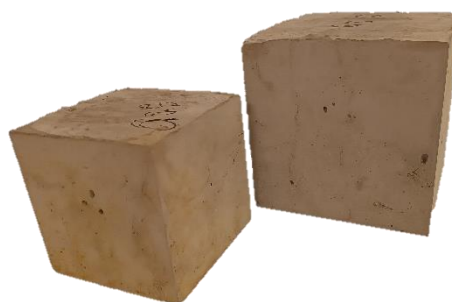
Obrázek 3 - zkušební tělesa o hraně 150 a 200 mm
