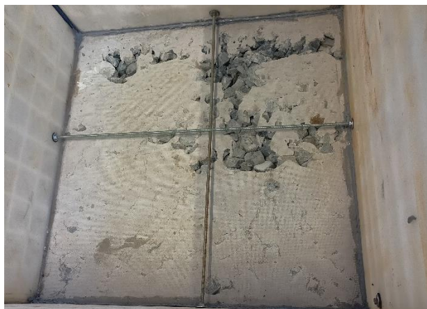
Obrázek 27 - reálný vzorek (pohled do zkušební nádrže na připravený vzorek)
