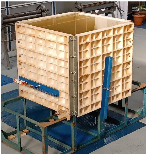
Obrázek 29 - reálný vzorek (pohled na napuštěnou nádrž, úroveň vody 80 cm)
