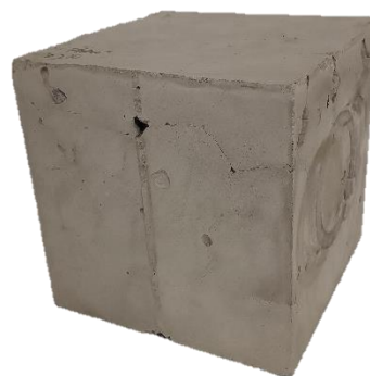
Obrázek 14 - směs CEM III + přísady (finální vyhotovený vzorek)
