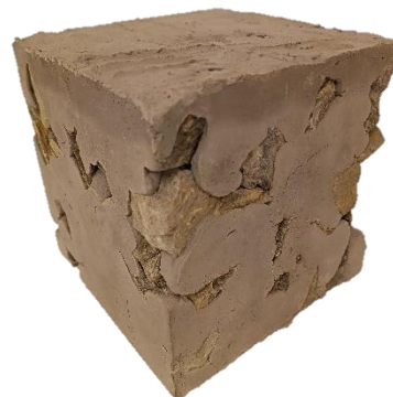
Obrázek 15 - směs Sorfix „A“ (vyhotovený vzorek po vodní lázni)
