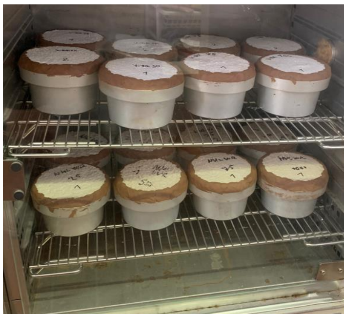
Obr. 18 Misky se vzorky v klimatické komoře
