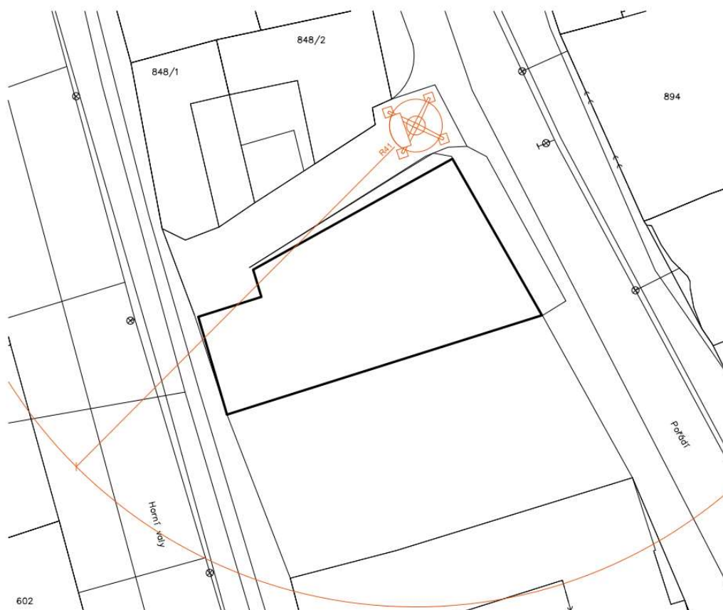
Obrázek 6 - délka dosahu výložníku jeřábu [Zdroj: vlastní tvorba]
