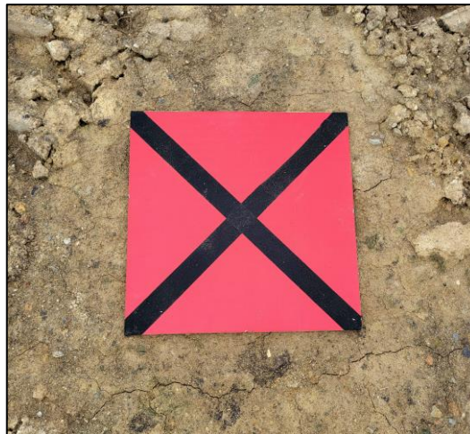
Obr. 15: Vlícovací bod s reflexní fólií a křížem
