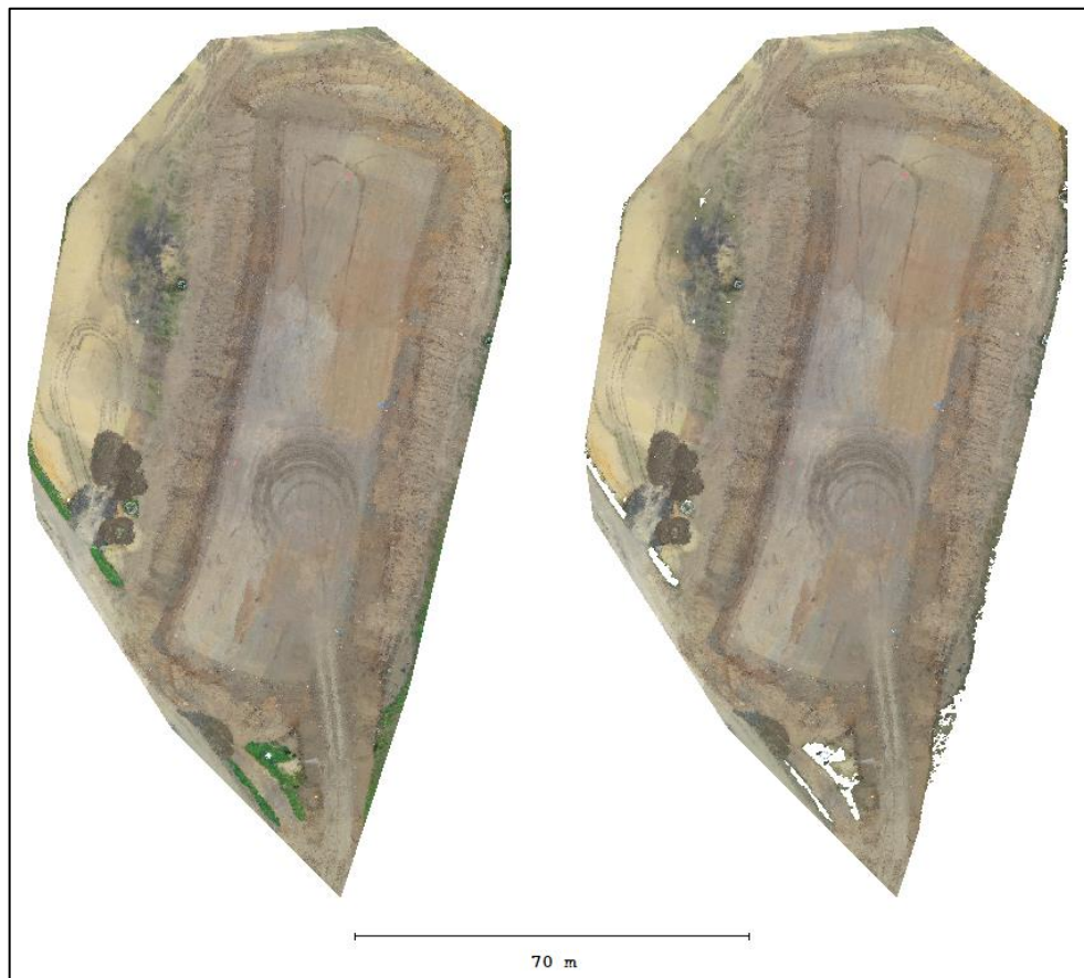
Obr. 36: Lidarové mračno před (vlevo) a po odstranění vegetace (vpravo)
