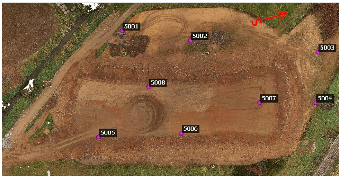
Obr. 16: Schéma rozmístění vlícovacích bodů
