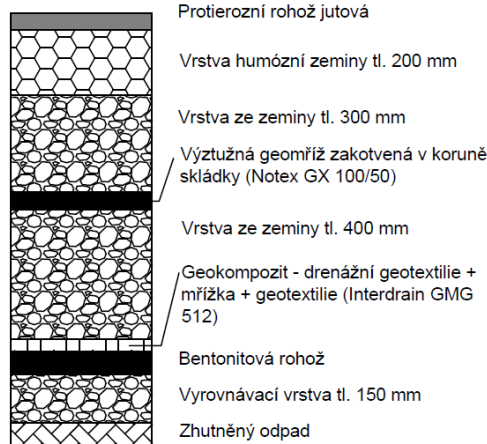
Obr. č. 19 – Schéma těsnicí vrstvy užití při rekultivaci skládky na horní ploše o sklonu max. 3 % (vlevo) a svahu ve sklonu 1:2 (vpravo)
