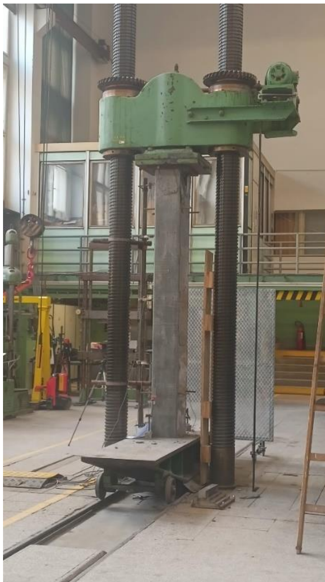
Obrázek 26: Betonový sloup ze skořepiny z UHPC
