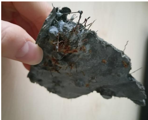
Obrázek 2: Drátky v UHPC
