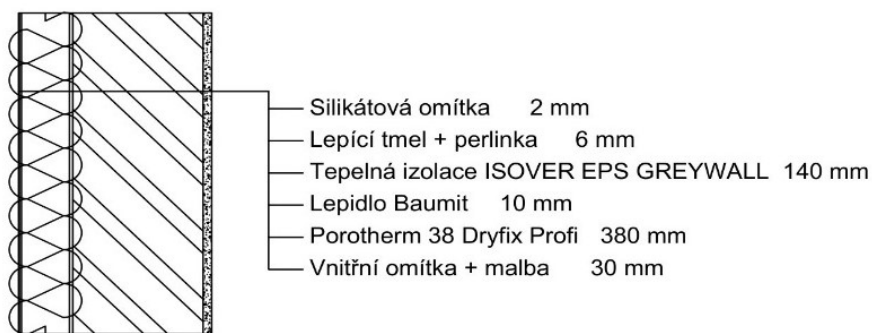
Obr. 2 - Skladba obvodové stěny
