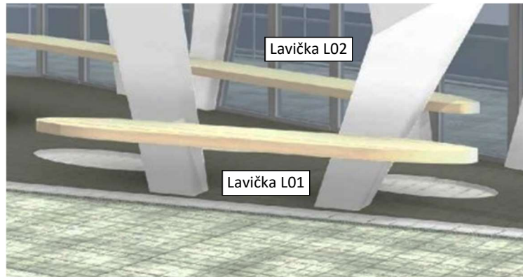
Obr. 4.5 – Pohled na lavičky přichycené na sloupky pomocí úhelníků
