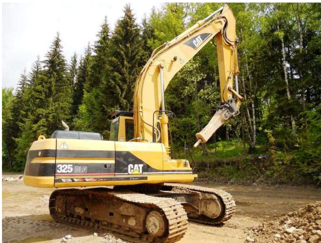
Obrázek 17 Impaktor Caterpillar na pásovém podvozku [7]
