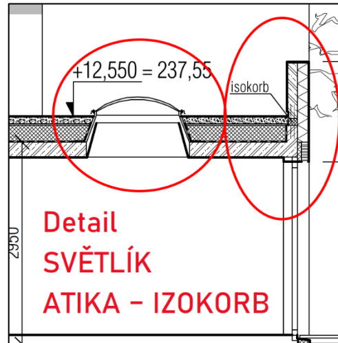
Obrázek 33 Chybějící detail – světlík, atika (Zdroj: Vlastní zpracování na základě PD)
