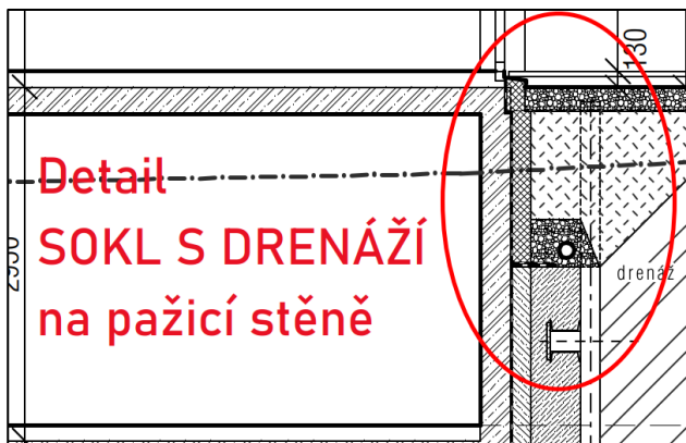
Obrázek 29 Chybějící detail – sokl nad drenáží (Zdroj: Vlastní zpracování na základě PD)
