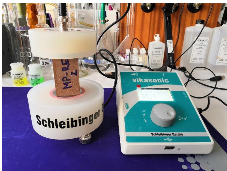
Obr. 32: Měření dynamického modulu pružnosti přístrojem Vikasonic [autor]
