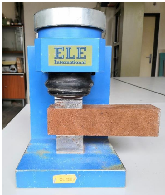
Obr. 31: Zkušební stolice ELE International pro zkoušku pevnosti v tlaku [autor]
