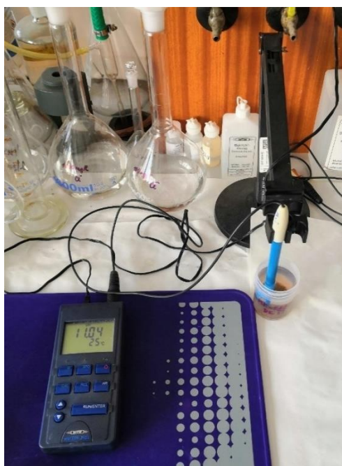
Obr. 41: Měření pH pomocí přístroje pH/ION 340 a sondy pH – Elektroda SenTix 21 [autor]
