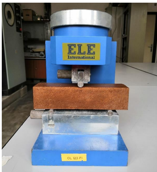
Obr. 30: Zkušební stolice ELE International pro zkoušku pevnosti v tahu za ohybu [autor]
