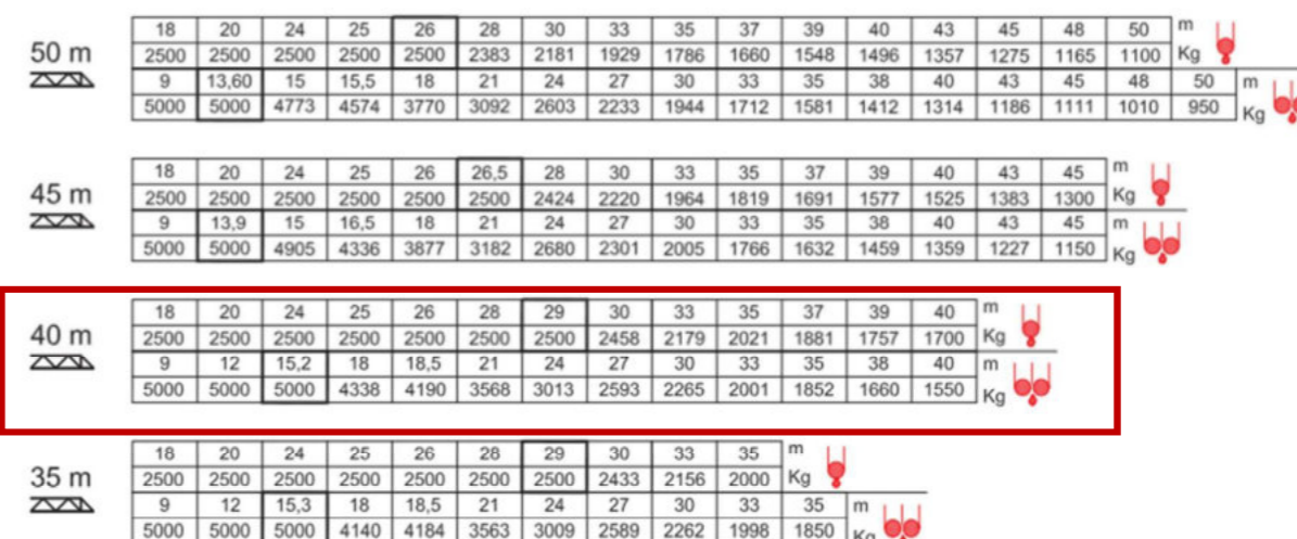
OBR. č. 1- POSOUZENÍ ZVOLENÉHO ZDVIHACÍHO PROSTŘEDKU
