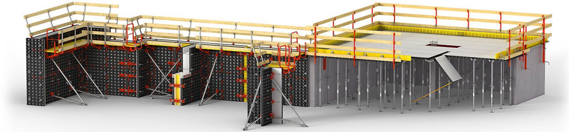
Obr. 4 Schéma debnenia Peri Duo
