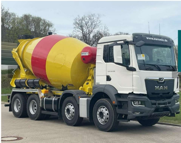
Obrázek 5 Autodomíchávač na beton pro ztužující stěny [převzato [21]]
