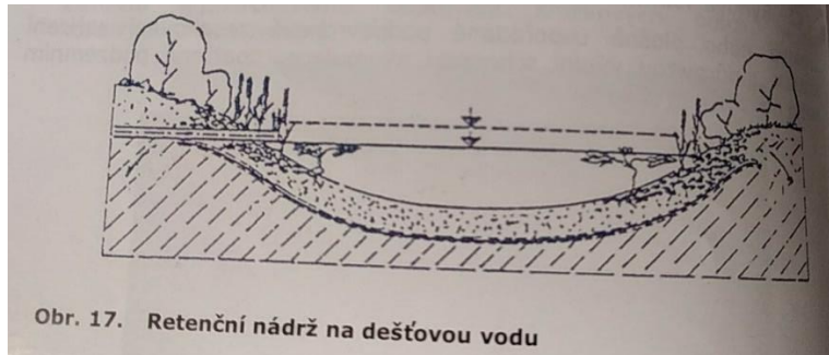
Obr. 17. Retenční nádrž na dešťovou vodu
