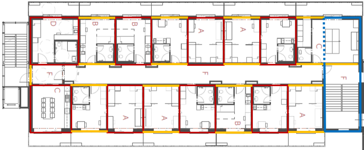
Obrázek 10.: zvolený systém panelování podlaží nástavby
