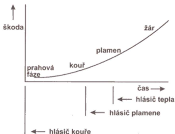
Obr. 4 - Vhodná detekcia v závislosti na vývojových fázach požiaru [8]
