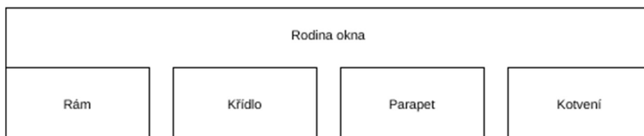
Obr. 24 – Koncept vymodelování všech částí uvnitř rodiny okna
