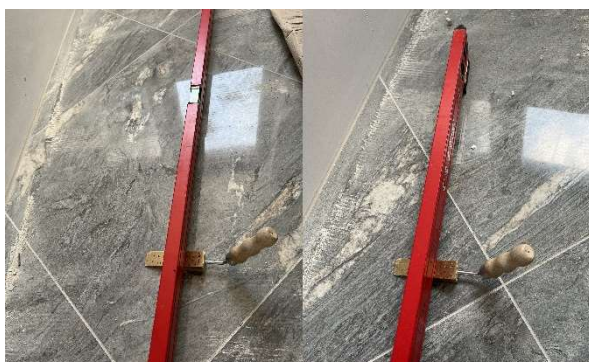
Obrázek 19: Měření latí s rektifikovatelnými podložkami a klínkem na dlažbě (vlastní)
