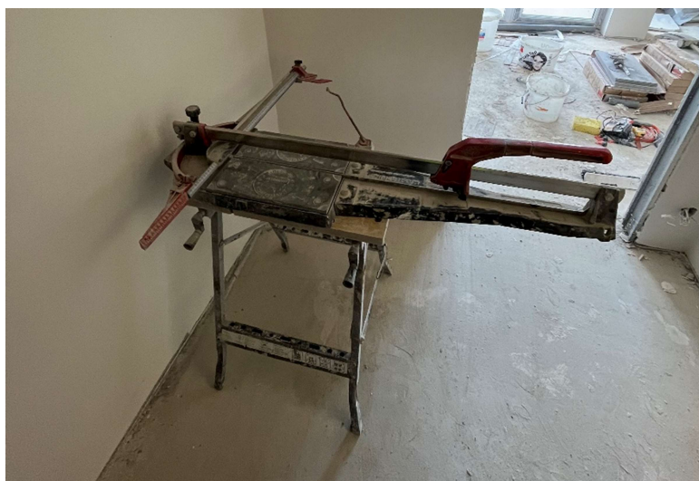
Obrázek 15: Řezačka s odlamovacími kleštěmi (vlastní)
