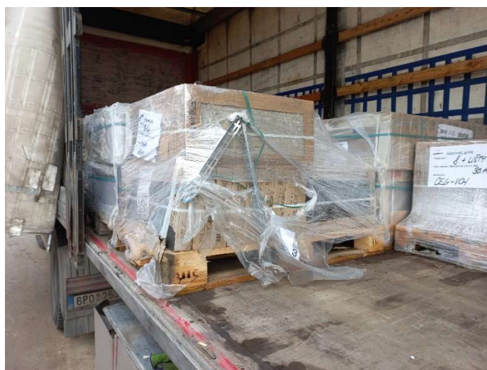
Obrázek 4: Ohnutá spádová lišta z přepravy (vlastní)
