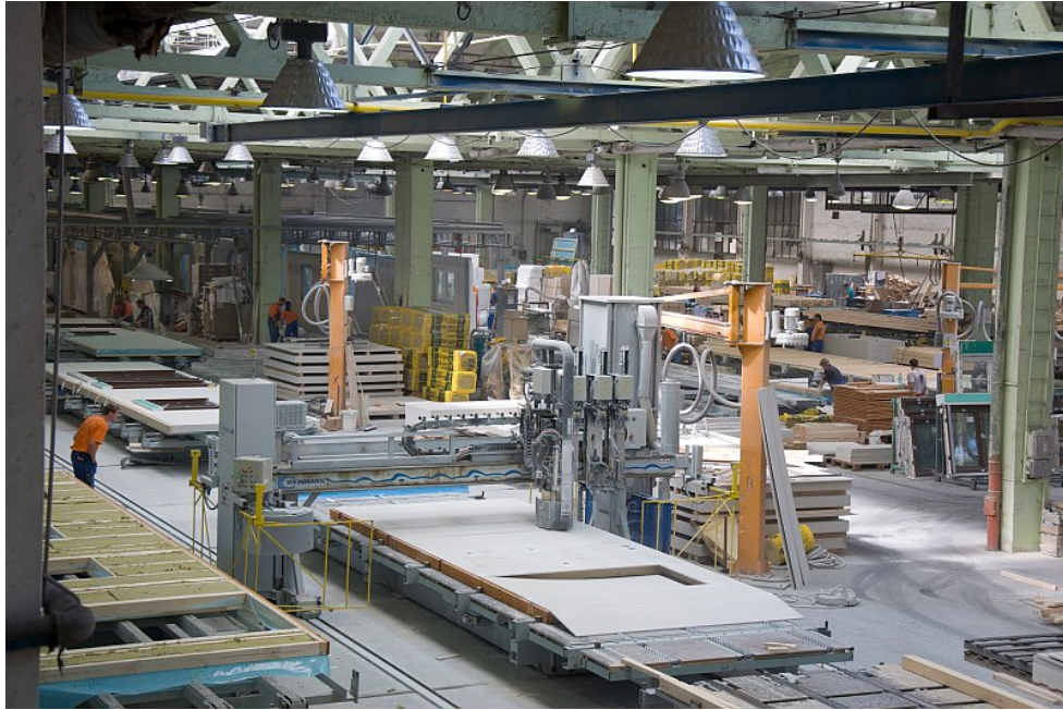
Obrázek 8 Hala na panelové dřevostavby (16)
