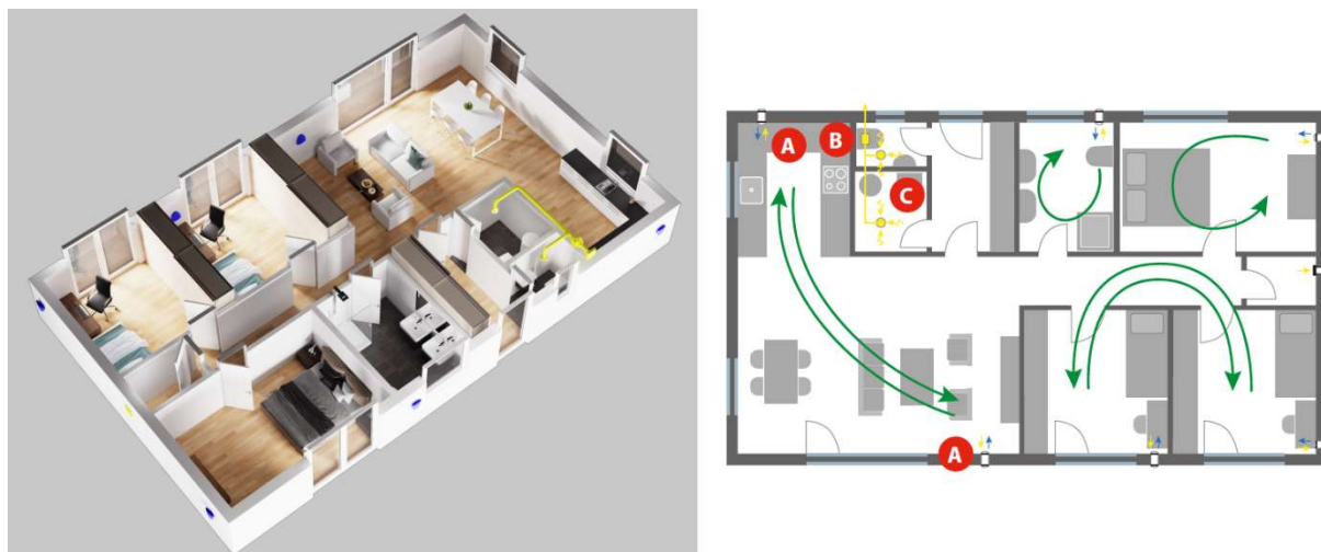
Obr. 18: Rovnotlaké lokální větrání [30]
