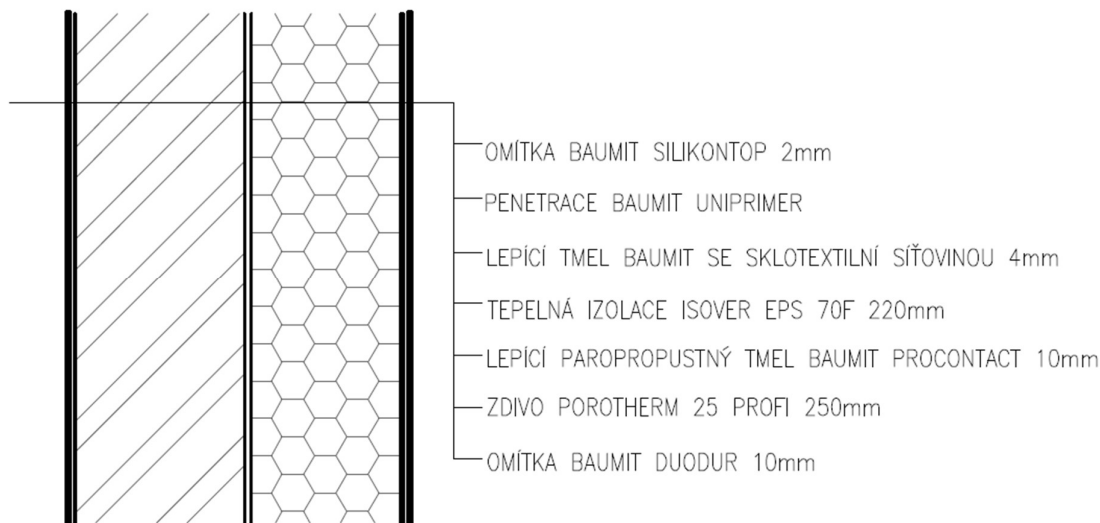
Obrázek 1-S1 viz. 501_Výkaz svislých konstrukcí
