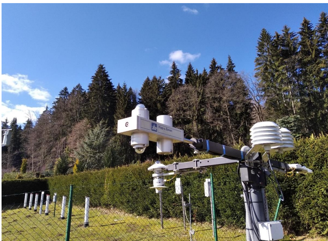
Obrázek 36: Měření radiace na meteorologické stanici Na Lizu
