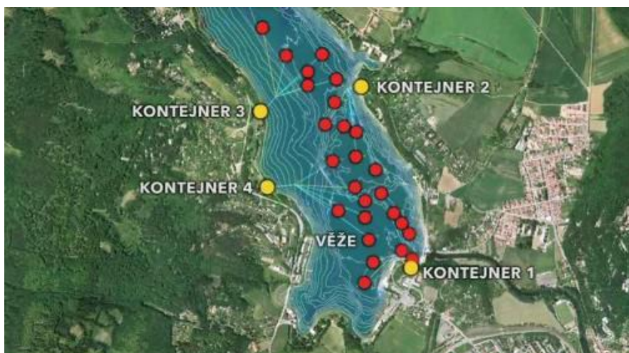
Obrázek 7-1: Rozmístění aeračních věží po nádrži (Zdroj: ČT Brno)
