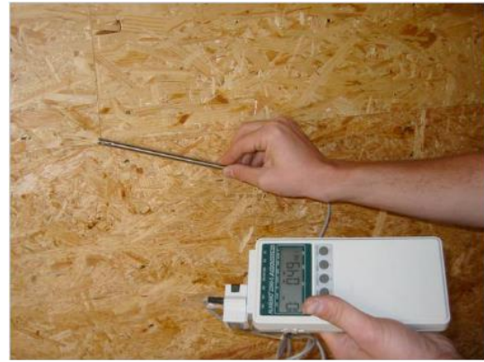
Obrázek 4-Měření vzduchotěsnosti OSB desky pomocí anemometru [4]
