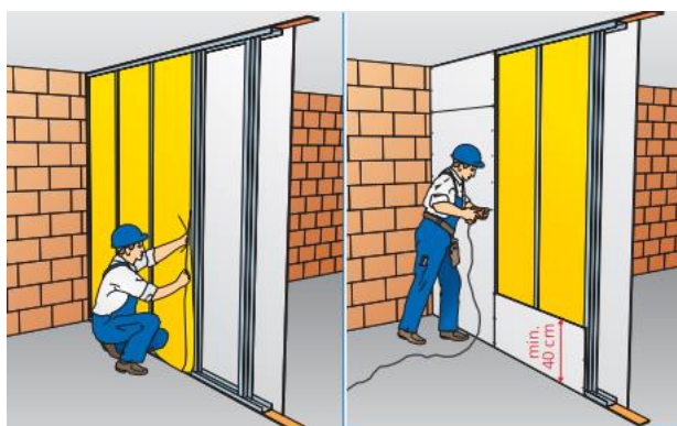
Obrázek 3: Vložení izolace a opláštění druhé strany příčky [45]
