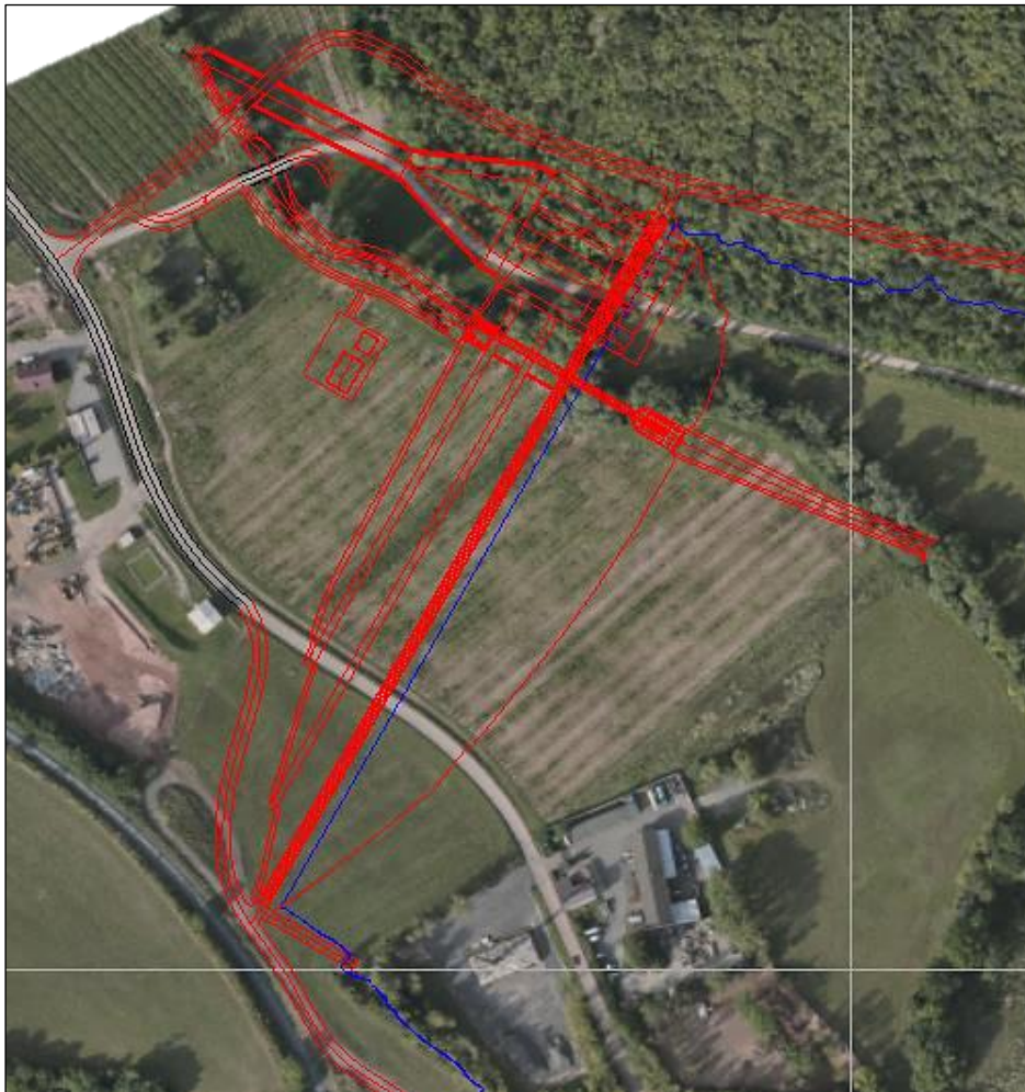
Obr.4.2 – Ortofoto náhled varianty B na hráz, objekty a obrys zátopy při H_{max}
