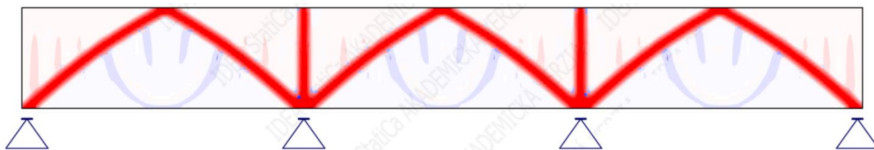
Obrázok číslo 4.7 – trajektórie tlakových a ťahových napätí z programu IDEA StatiCa pre model M1
