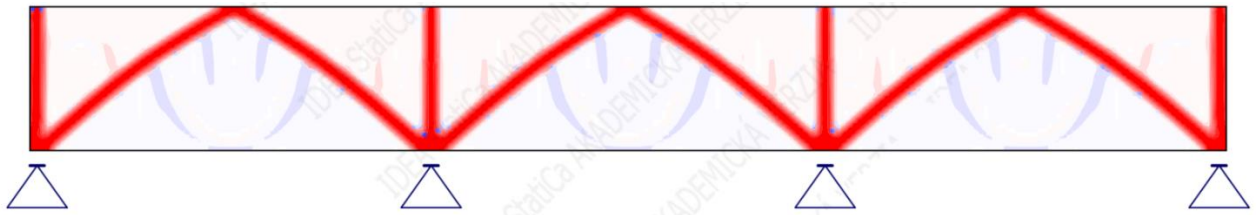
Obrázok číslo 4.12 – trajektórie tlakových a ťahových napätí z programu IDEA StatiCa pre model M2
