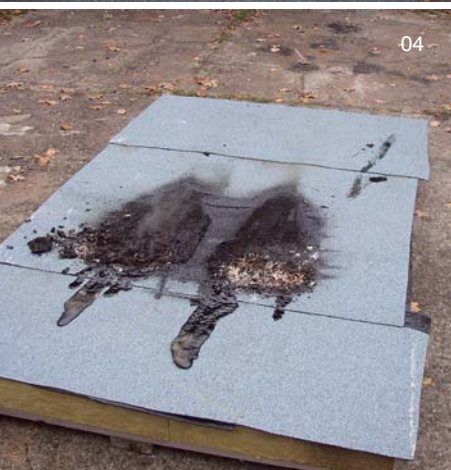
03| průběh zkoušky šíření plamene střešním pláštěm 04| zkoušený vzorek po ukončení zkoušky
