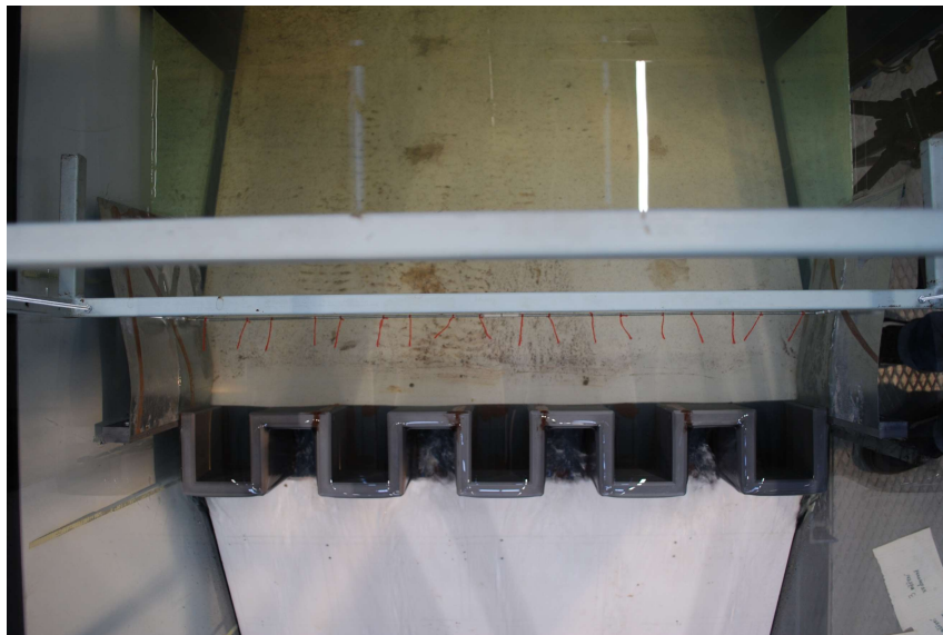
Obr. A.1.3: Směr proudnic pro Q = 5 l/s, 2. vodorovná poloha, 3. svislá poloha
