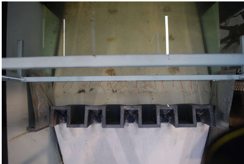
Obr. C.2.3: Směr proudnic pro Q = 5 \text{ l/s} , 2. vodorovná poloha, 3. svislá poloha
