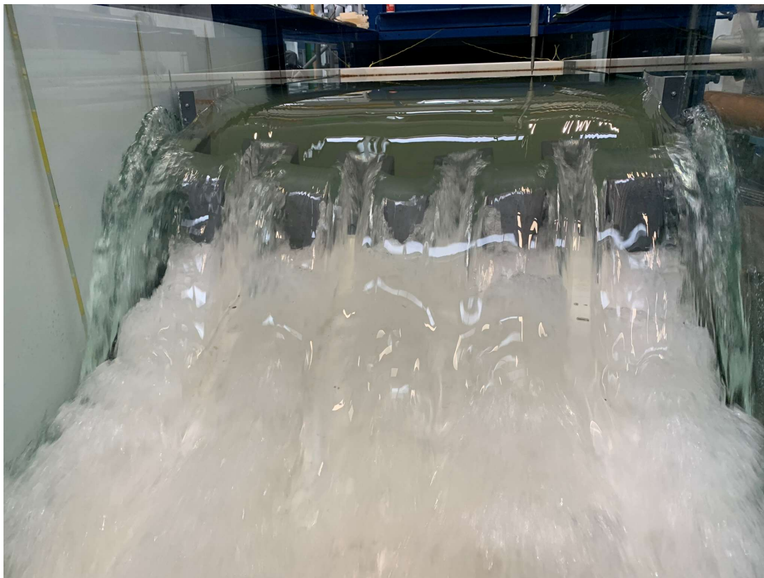
Obr B.9: Pohled na přepad, Q = 150 l/s
