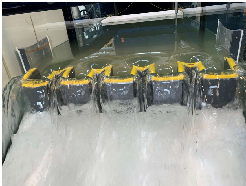
Obr. A.2.2: Pohled na přeliv, Q = 45 l/s
