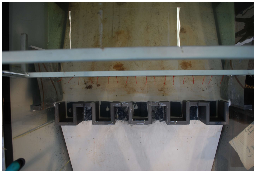
Obr. D.3: Směr proudnic pro Q = 5 l/s, 2. vodorovná poloha, 4. svislá poloha
