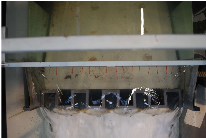
Obr. C.2.5: Směr proudnic pro Q = 90 l/s, 2. vodorovná poloha, 5. svislá poloha
