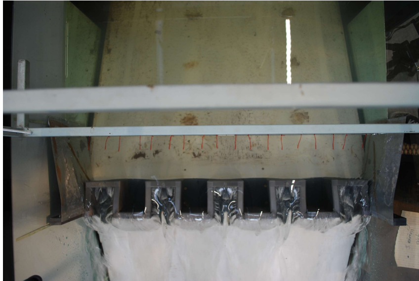
Obr. C.2.4: Směr proudnic pro Q = 45 l/s, 2. vodorovná poloha, 4. svislá poloha
