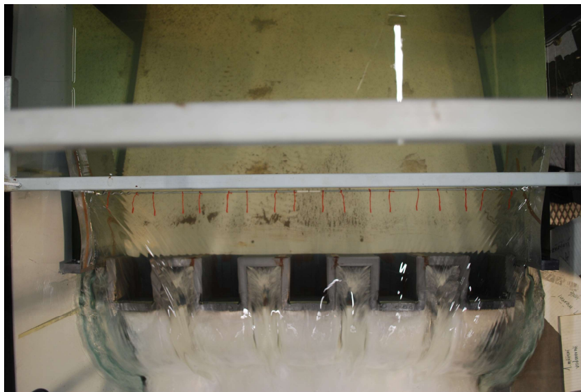
Obr. A.1.5: Směr proudnic pro Q = 90 l/s, 2. vodorovná poloha, 5. svislá poloha
