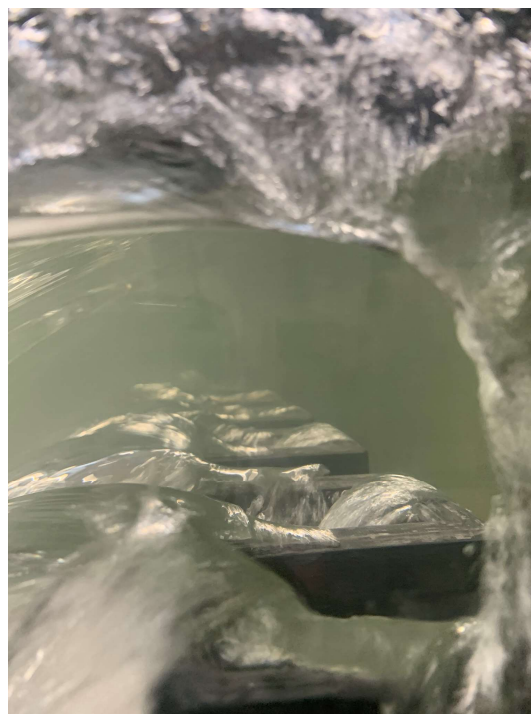
Obr. A.1.8: Pohled do přepadu, Q = 150 l/s
