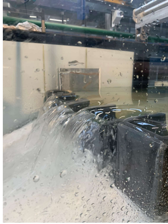
Obr. D.2: Pohled na přepad – Q = 25 l/s
