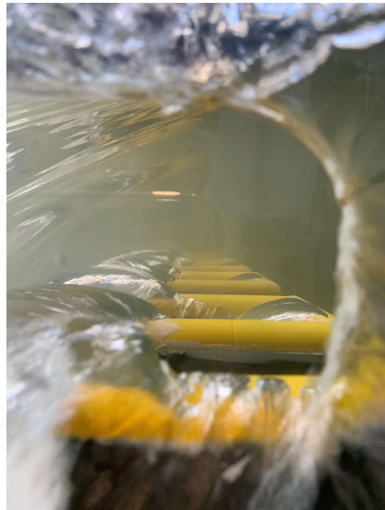
Obr. A.2.5: Pohled do přepadu, Q = 12 l/s
