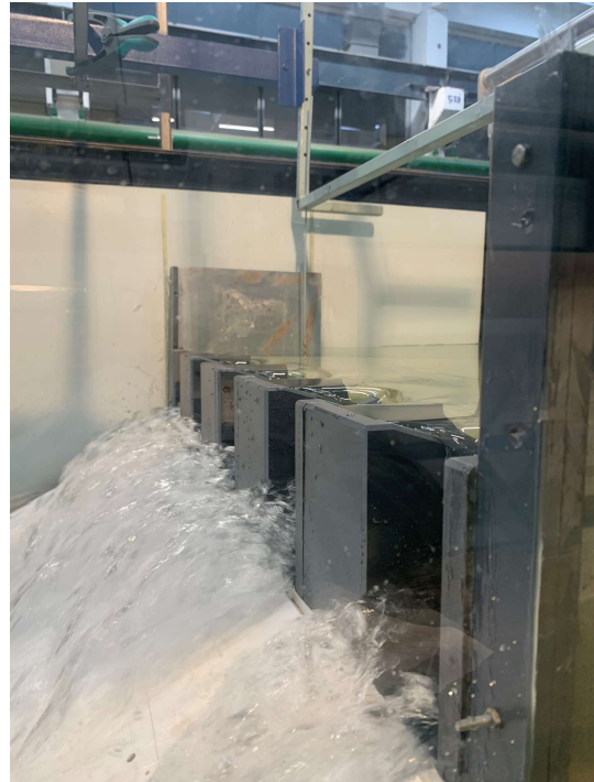
Obr. C.2.2: Pohled na přepad – Q = 5 \text{ l/s}
