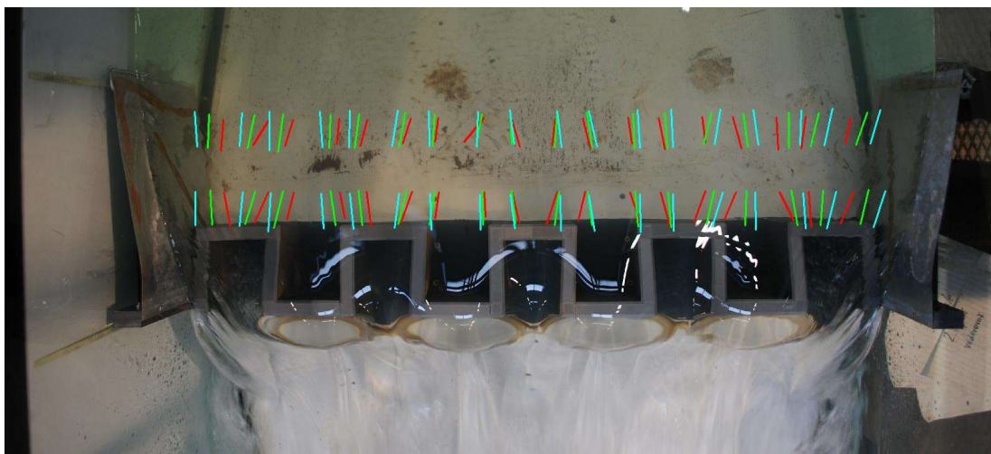
Obr. 4.5: Vyznačené směry proudnic pro 5 l/s (červená), 45 l/s (zelená) a 90 l/s (modrá) v nátokovém poli typu VS3 – Varianta II. v 1. a 2. vodorovné poloze
