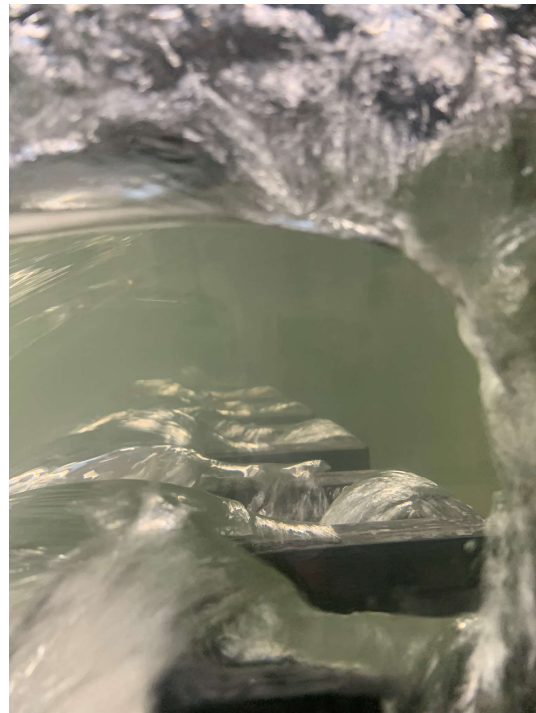
Obr. C.1.8: Pohled do přepadu, Q = 150 l/s
