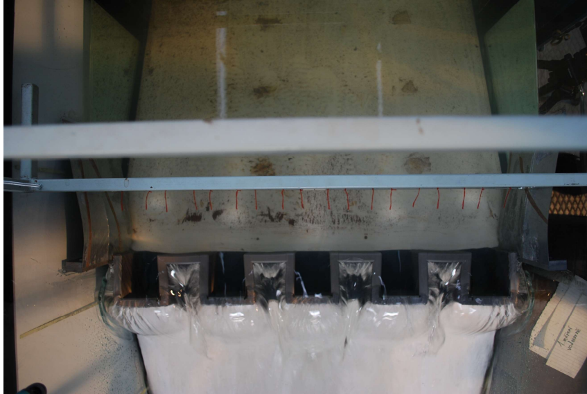
Obr. B.4: Směr proudnic pro Q = 45 l/s, 2. vodorovná poloha, 4. svislá poloha
