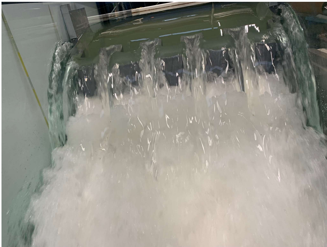
Obr A.1.9: Pohled na přepad, Q = 150 l/s
