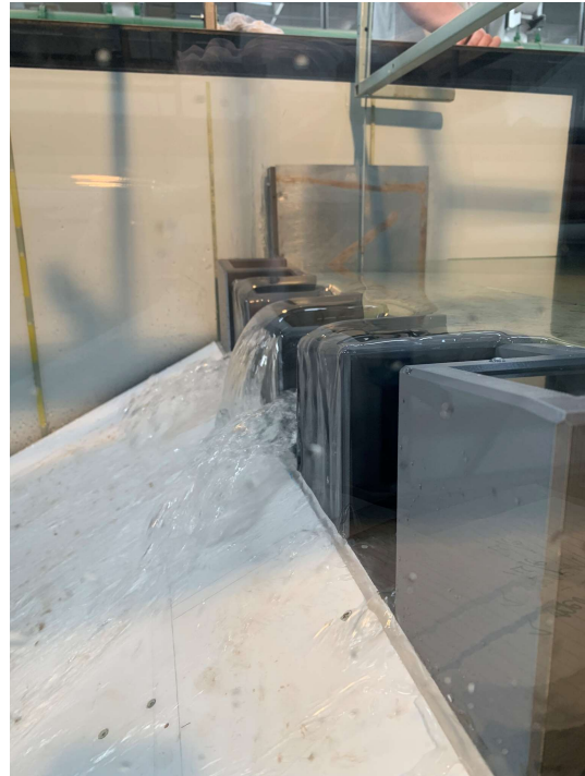
Obr. B.2: Pohled na přepad – Q = 5 \text{ l/s}
