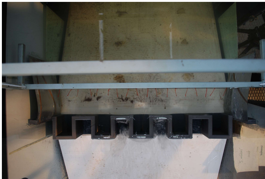
Obr. B.3: Směr proudnic pro Q = 5 \text{ l/s} , 2. vodorovná poloha, 4. svislá poloha
