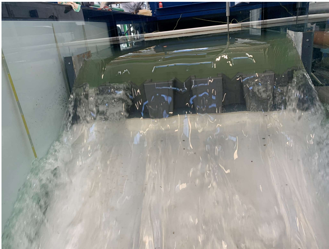
Obr. C.2.9: Pohled na přepad, Q = 150 l/s
