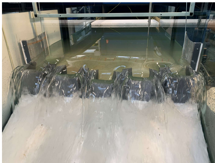
Obr. D.6: Pohled na přeliv, Q = 45 \text{ l/s}
