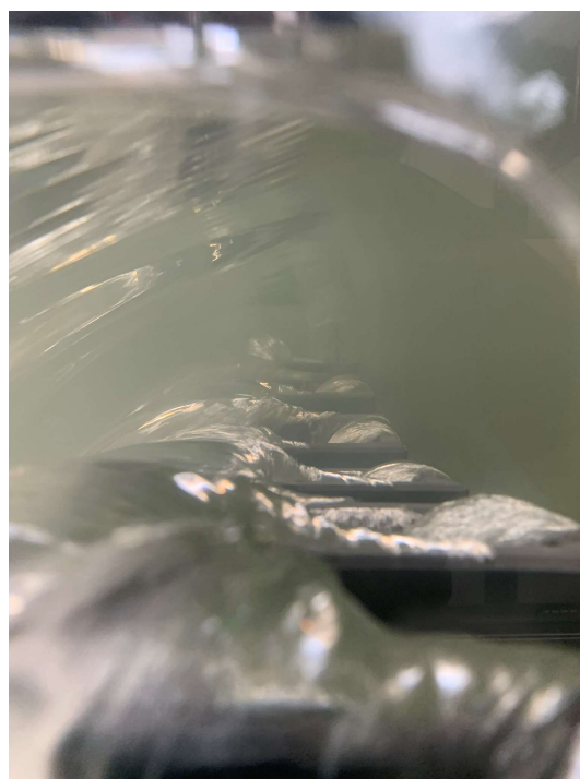
Obr. B.8: Pohled do přepadu, Q = 150 l/s
