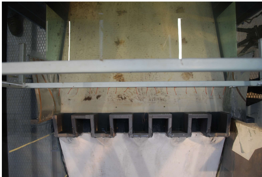
Obr. C.1.3: Směr proudnic pro Q = 5 l/s, 2. vodorovná poloha, 3. svislá poloha
