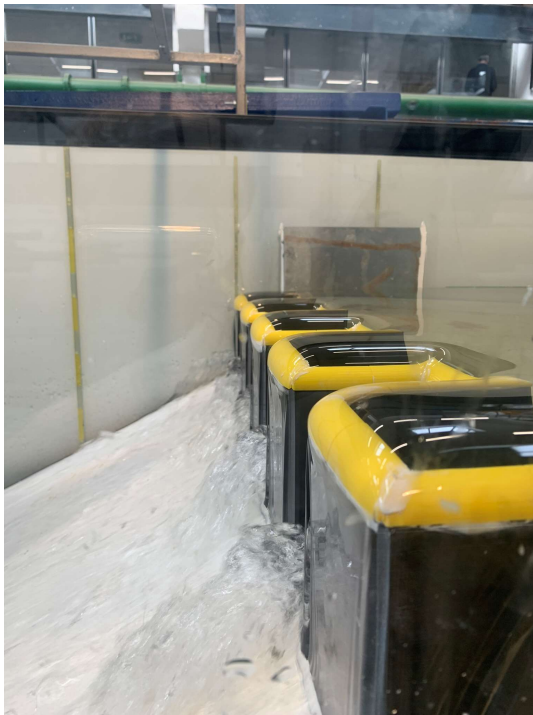
Obr. A.2.4: Pohled do přepadu, Q = 5 l/s
