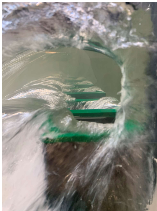
Obr. A.3.5: Pohled do přepadu, Q = 120 l/s
