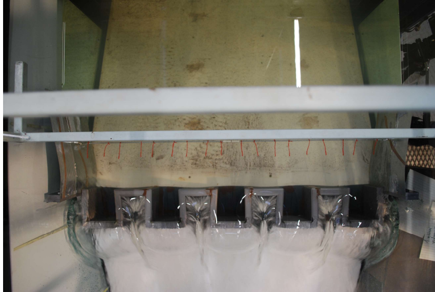
Obr. A.1.4: Směr proudnic pro Q = 45 l/s, 2. vodorovná poloha, 4. svislá poloha
