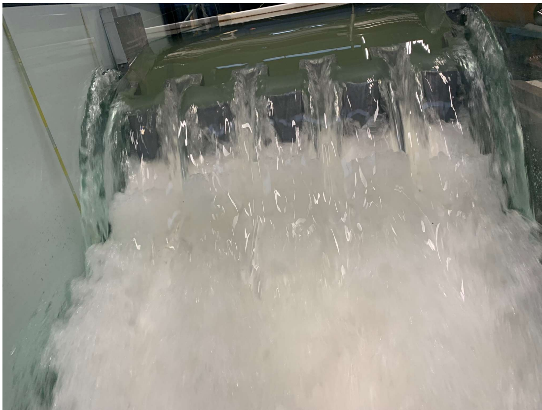
Obr. C.1.9: Pohled na přepad, Q = 150 l/s
