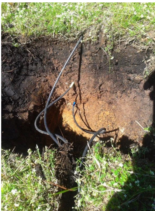
Obrázok 3 Inštalácia teplotných sond 107 (Fotografia: Michal Dohnal, 2017)
