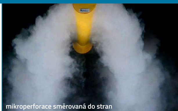
Příklady obrazů proudění vytvořených kouřovou zkouškou ve zkušebně PŘÍHODA s.r.o.
