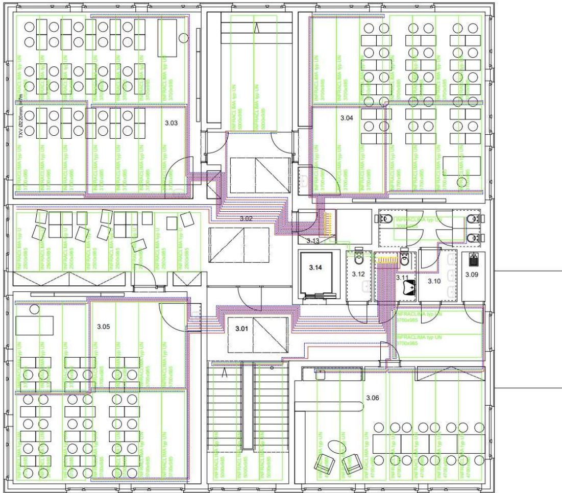
Obrázek 28: Příklad konceptu stropního vytápění v budově MŠ v 1.NP
