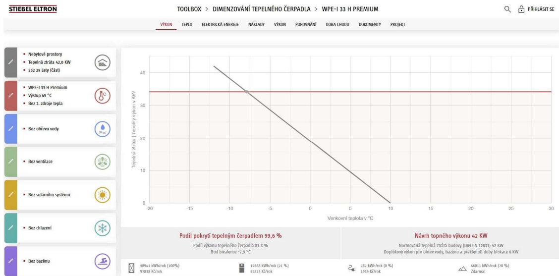
Obrázek 13: Návrh TČ země/voda dle programu od firmy Stiebel Eltron
