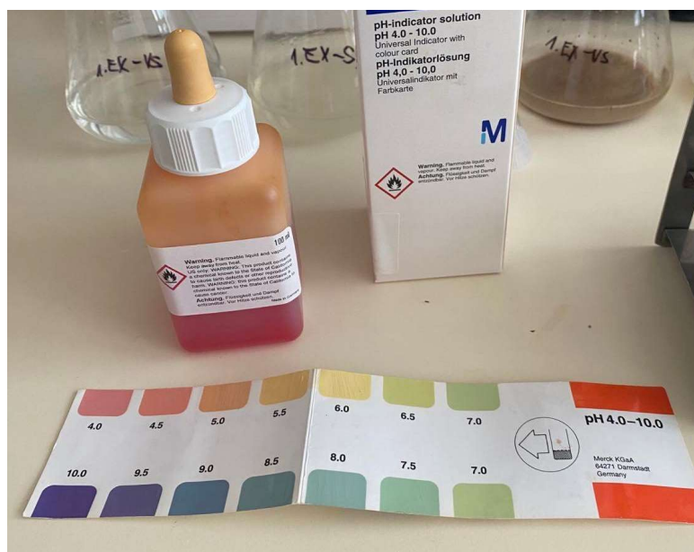
Obrázek 77: Kolorimetrická stupnice a acidobazický indikátor pH
