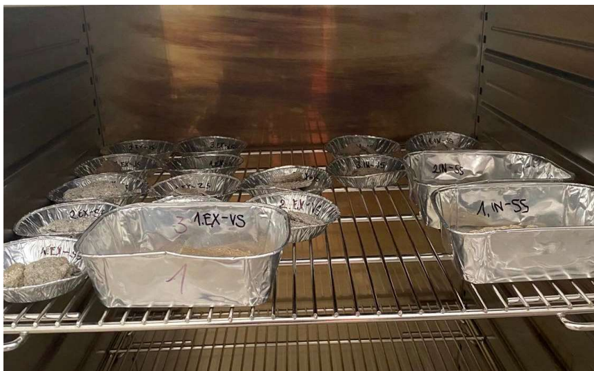
Obrázek 66: Nevysušené vzorky v hliníkových miskách umístěné do sušárny
