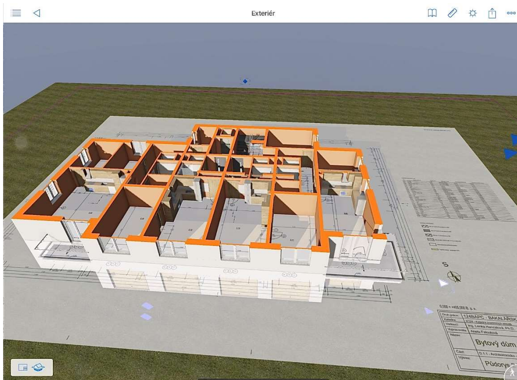
Obrázek 45 - Propojení výkresové dokumentace s 3D prostředím v BIMx
