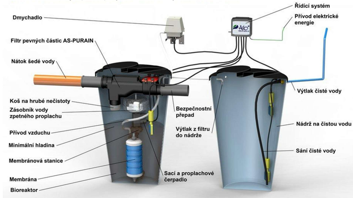
Obrázek 27 - Schéma pro recyklaci šedých vod AS-GW/AQUALOOP
