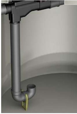
Obrázek 29 – Zklidnění proudu nátokové vody
