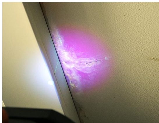
Obr. 31 - Zátopová zkouška s UV barvivem [43] Obr. 32 - Pomocí UV objevený průsak [43]
