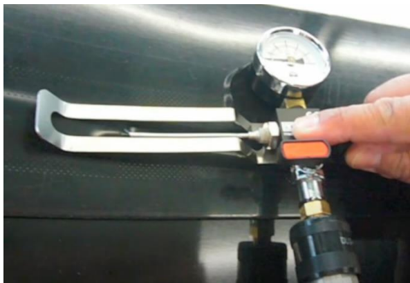
Obr. 30 - Zkušební tlaková jehla napojena do dvoustopého sváru [42]
