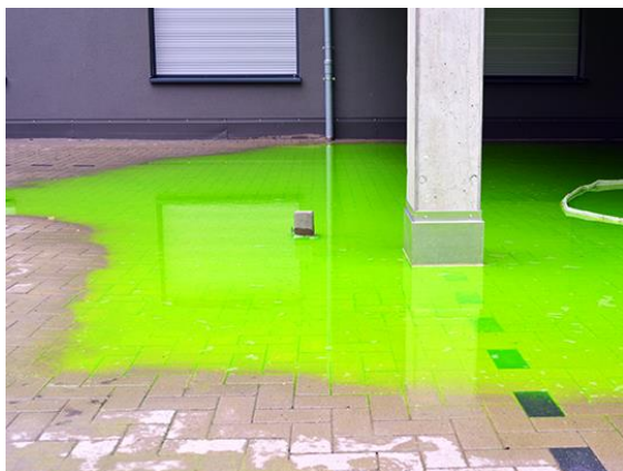
Obr. 31 - Zátopová zkouška s UV barvivem [43] Obr. 32 - Pomocí UV objevený průsak [43]
