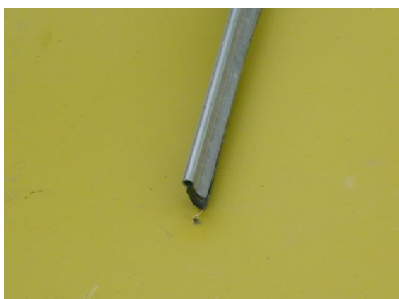
Obr. 60 - Defekt odhalený jiskrovou zkouškou [65]
