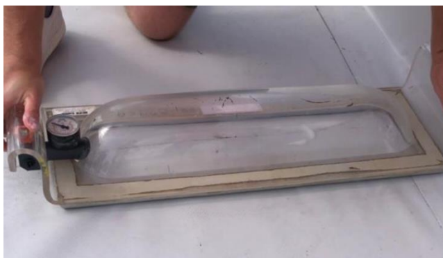
Obr. 27 - Zkouška těsnosti pomocí vakuového zvonu [39]
