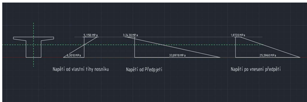
Obrázek 5-13 Napětí na průřezu
