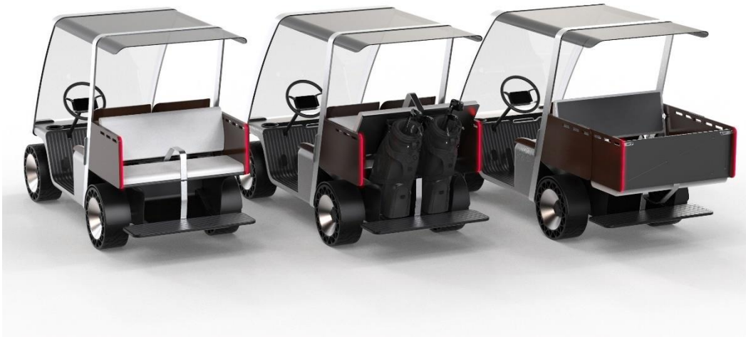
Obrázek 27 Varianty využití zadní části vozíku po složení sedačky, režim sedadla, režim golfových bagů, režim korby
