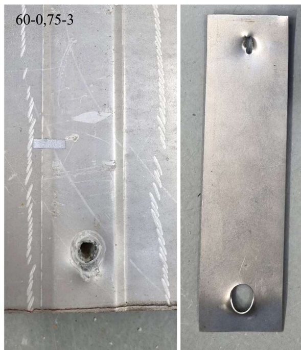
Obr. 54 Zkouška 60-0,75-3 – způsob porušení
