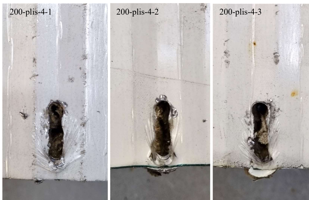
Obr. 60 Porušení panelu – zkoušky 200-plis-4
