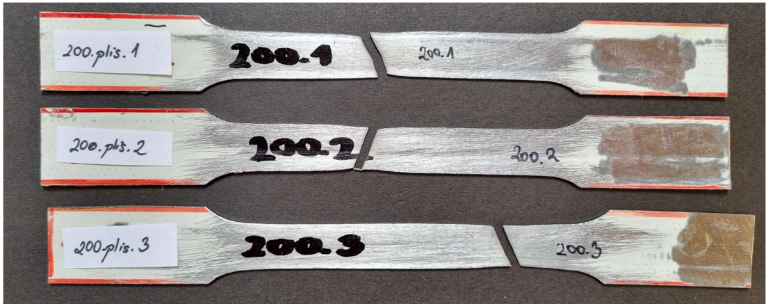
Obr. 66 Porušení zkušebních těles 200.plis.1–200.plis.3
