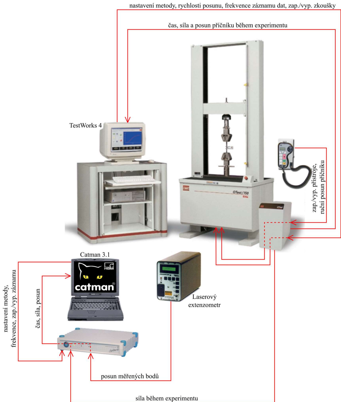
Obr. 16 Schéma propojení přístrojů a přenosu dat, zdroje obrázků: [18] [20] [21]
