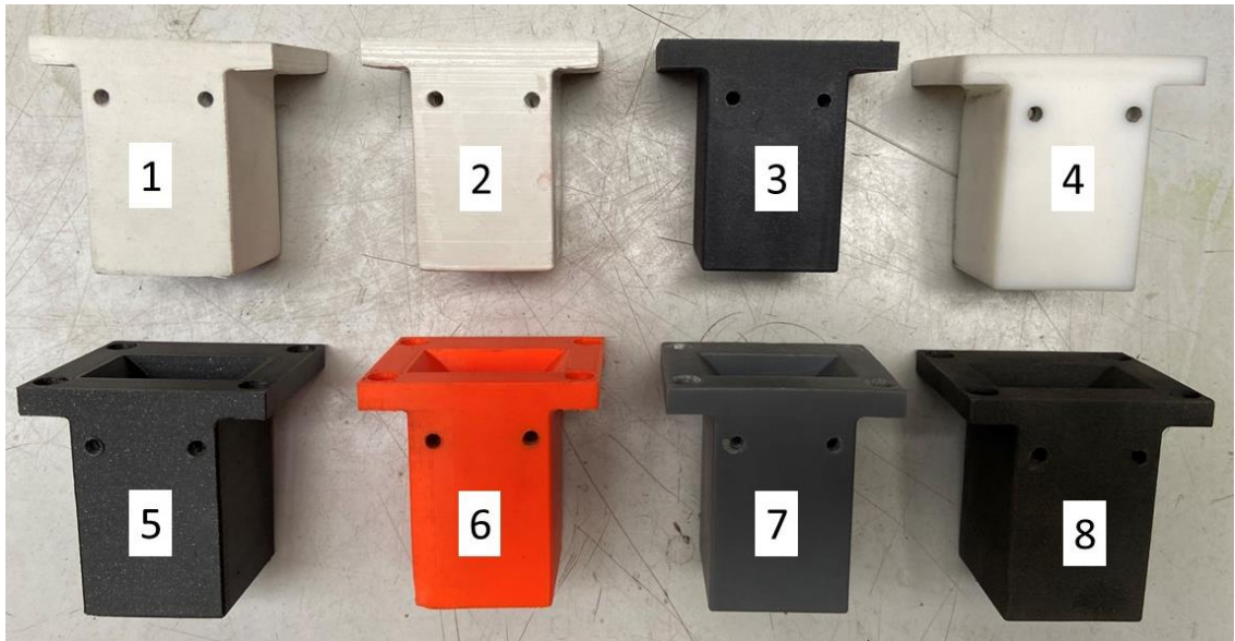
Obrázek 7 - Jednotlivé výtisky Lavalovy trysky: 1 - materiál ASA (FFF/FDM), 2 - materiál ASA-S (FFF/FDM), 3 - materiál PA 12 (MJF), 4 - materiál Rigid4000 (SLA), 5 - materiál PLA (FFF/FDM), 6 - materiál PETG (FFF/FDM), 7 - materiál Grey (SLA) a 8 - materiál PA 12 (SLS).
