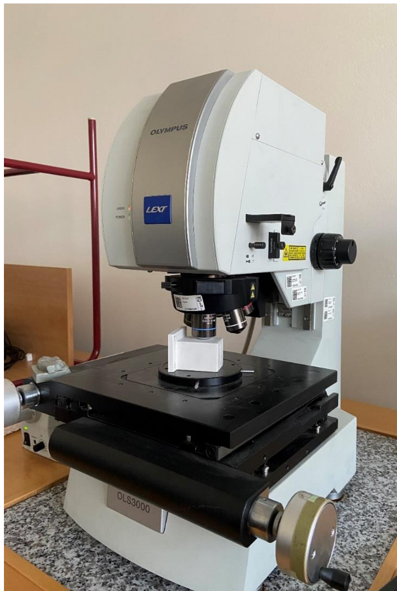
Obrázek 16 - Konfokální mikroskop – LEXT OLYMPUS 3000
