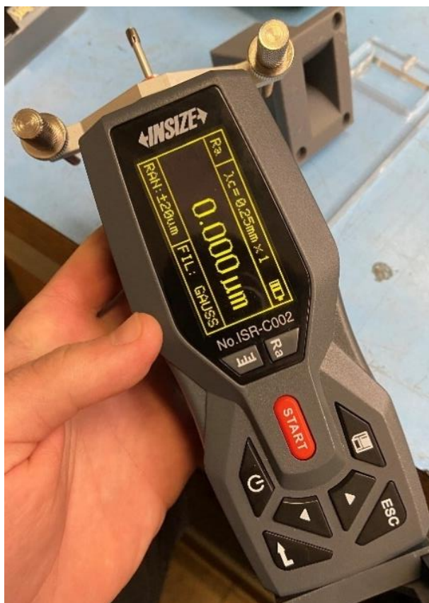
Obrázek 15 - Drsnoměr Insize ISR-C002
