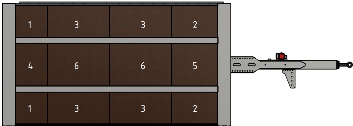
Obr. 46.: Rozložení desek podlahy
