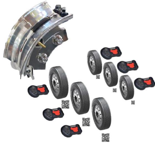
Obr. 36.: Umístění TPMS čidel na disku [24]
