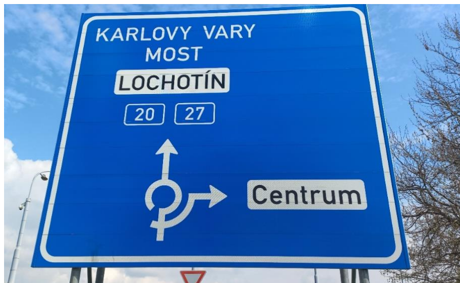
Obrázek 6 Příklad svislého dopravního značení s předurčeným využitím pruhu z TOK Plzeň – Rondel [vlastní fotografie]
