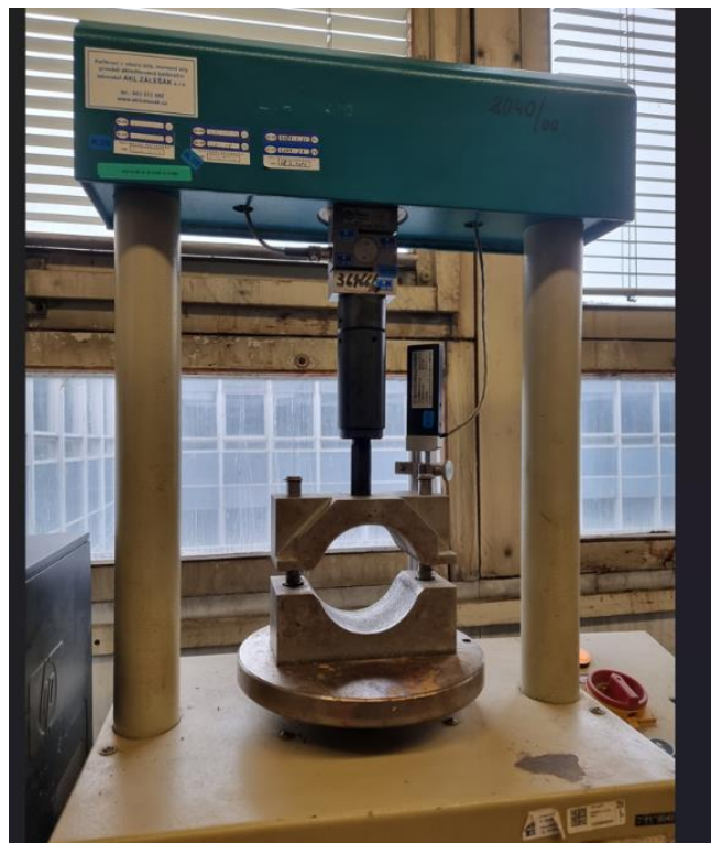
Obrázek 14 – Příklad pro provádění Marshallovy zkoušky (vlastní foto)
