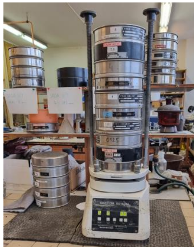
Obrázek 5 – Přístroj na mechanické prosévání se sloupcem sít (vlastní foto)
