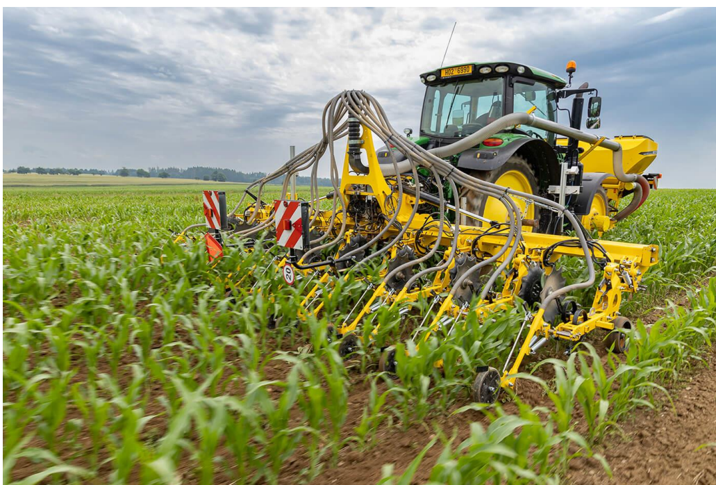
Obrázek 12: Rozvod hnojiva ze zásobníku [20]
