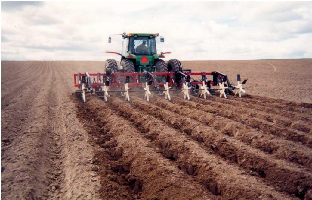
Obrázek 9: Vytváření hrázek v meziřádku brambor [31]
