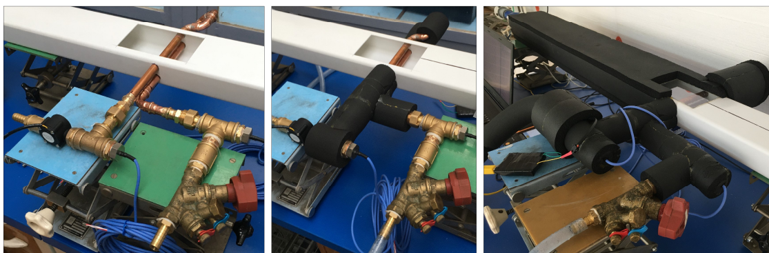
Obr. 3.12. Zaizolování experimentální tratě - postup práce
