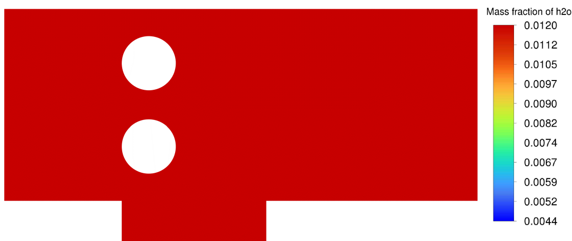
Obr. 5.1. Pole hmotnostního zlomku vodní páry na rovině symetrie - RH model
