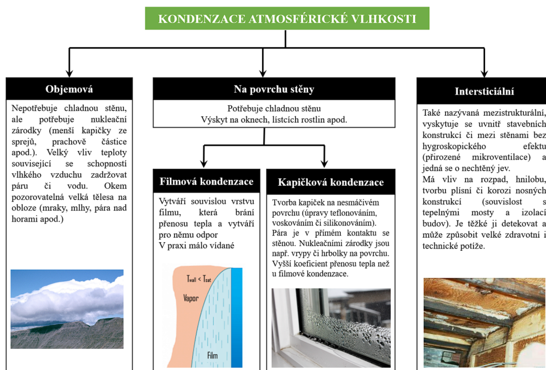
Obr. 1.1. Mechanizmy kondenzace (Barak, 2021)
