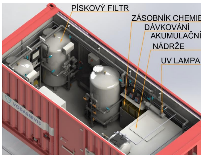
Obr. 51 Vnitřek úpravy vod
